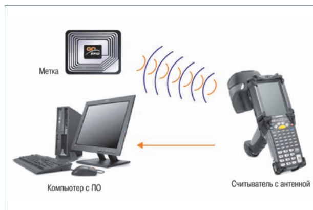
Рис. 1. Схема передачи информации по технологии RFID
