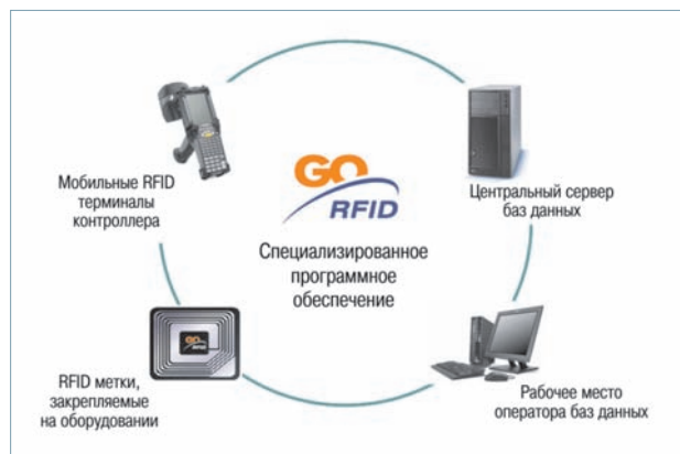
Рис. 2. Программно-аппаратный комплекс Go-RFID
