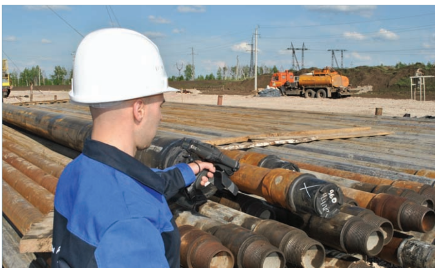
Рис. 2. Считывание информации с RFID-меток
