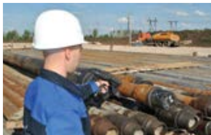
Считывание информации с RFID-меток
